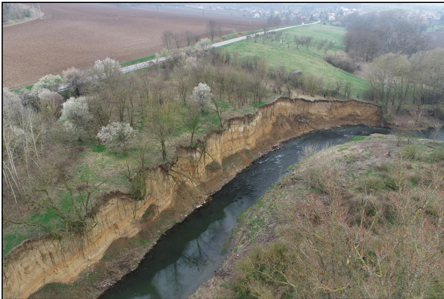
Využití dronů pro mapování svahových deformací. Svahová deformace charakteru řícení ve spraši v Podolí nad Olšavou (Zlínsko). Foto J. Nečas.
