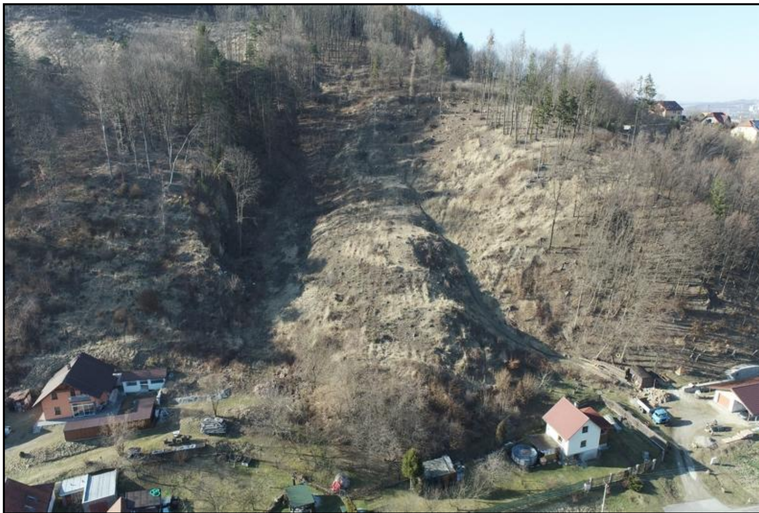
Využití dronů pro mapování svahových deformací. Svahová deformace charakteru zemního proudu v Jarovce na Vsetínsku. Foto J. Nečas.
